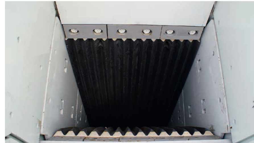
Optimierte Brechraumgeometrie mit langen Brechbacken
