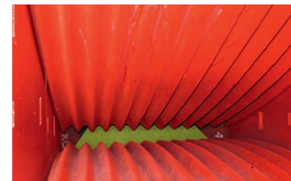
Abweisblech zur Schonung der Förderbandgurte
