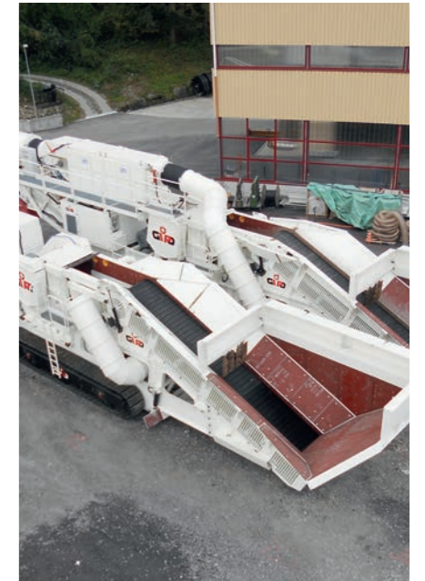
B 1185 FDR PB mit elektrischem Antrieb, Plattenband und Filteranlage für den Tunnelseinsatz
