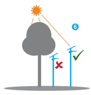
Para la máxima eficiencia operativa de los paneles solares, por favor asegúrese de que la luz del sol no está bloqueado por edificios o árboles.
