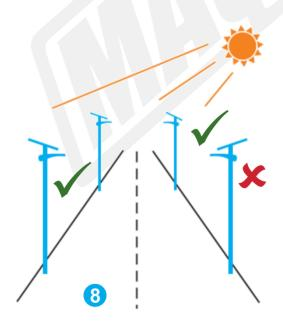
Cuando instala la lámpara Ave volador en dos lados de la carretera, por favor mantenga los paneles solares de dos lados en la misma dirección basado en lo explicado anteriormente en el punto 7
