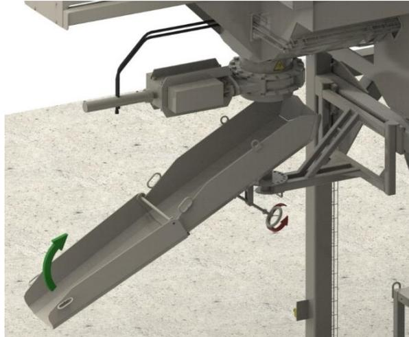
**⚠ ATTENTION !** L'opérateur doit s'assurer qu'aucune personne ne se trouve à proximité de la goulotte lors de l'ouverture et la fermeture de la trappe. **RISQUE D'ECRASEMENT ET DE COUPURE !**
